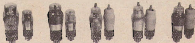
Rapporto fra la vecchia serie a 6,3 V — 300 mA e la nuova a 6,3 V. — 150 mA alla quale appartengono le valvole di dimensioni più piccole.
